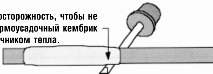
Рис. 5: Надвиньте термоусадочный кембрик на паяное соединение.
